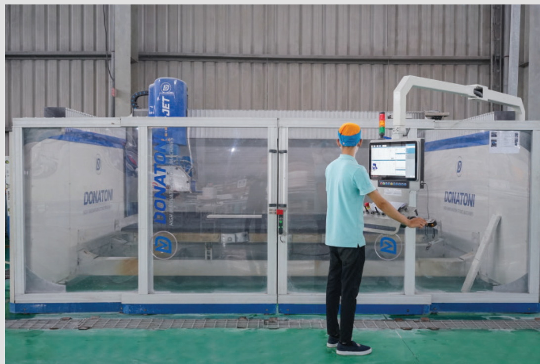
Máy phay cầu DONATONI DONATONI CNC bridge milling machine
