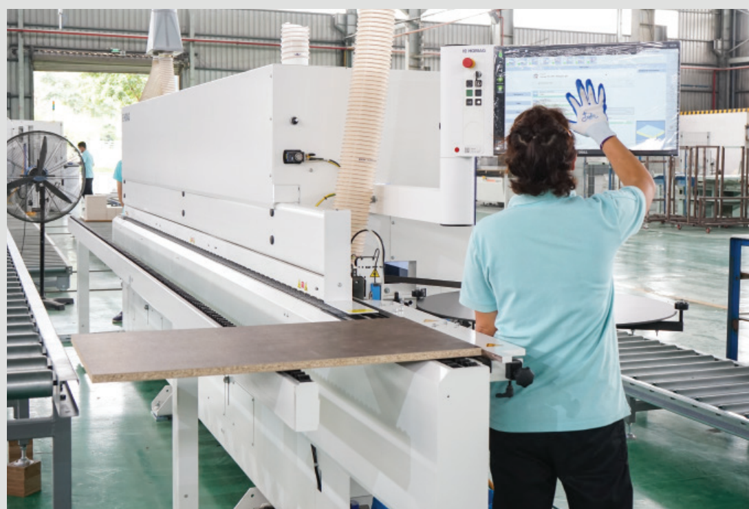
Máy dán chỉ cạnh HOMAG HOMAG edge banding machine
